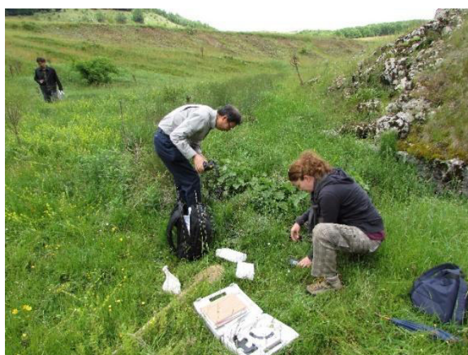
Terenski obilazak i postavljanje karbonatnih tableta na terenu za analizu dinamike ciklusa kruženja ugljenika u prirodi i njegovog uticaja na karstni proces Field trip and setting up of carbonate tablets in the ground to analyse the dynamics of the carbon cycle in nature and its impact on the karst process
